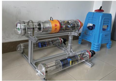
图11 渔业养殖监测用AUV样机
